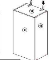
►9 ! Заглушки Z2 евровинтов B1 устанавливаются на крайние модули, на видимую сторону
